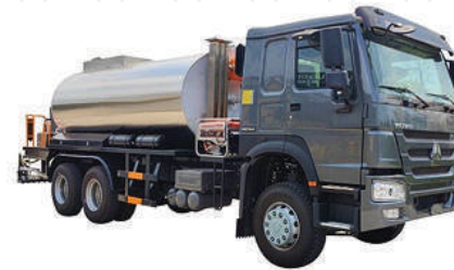
Tak Coat Tanker
